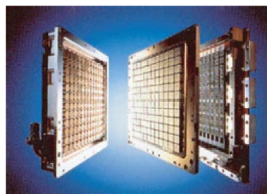
スーパーコンピュータの中央演算素子と多層セラミックス基板
