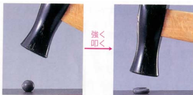
図 34 金属の展性 鉛をハンマーで叩く。
