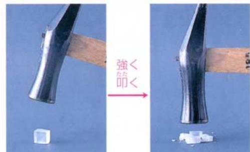
図 19 イオン結晶のもろさ(NaCl 結晶)
