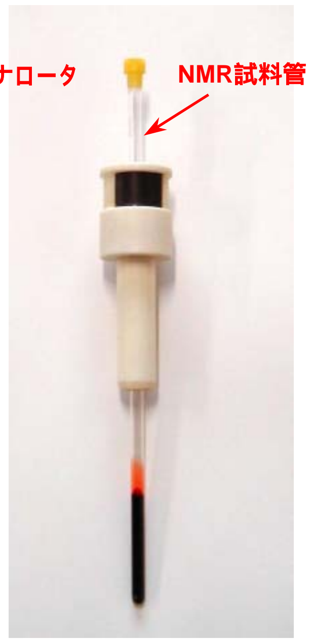
試料管をセットしたところ
