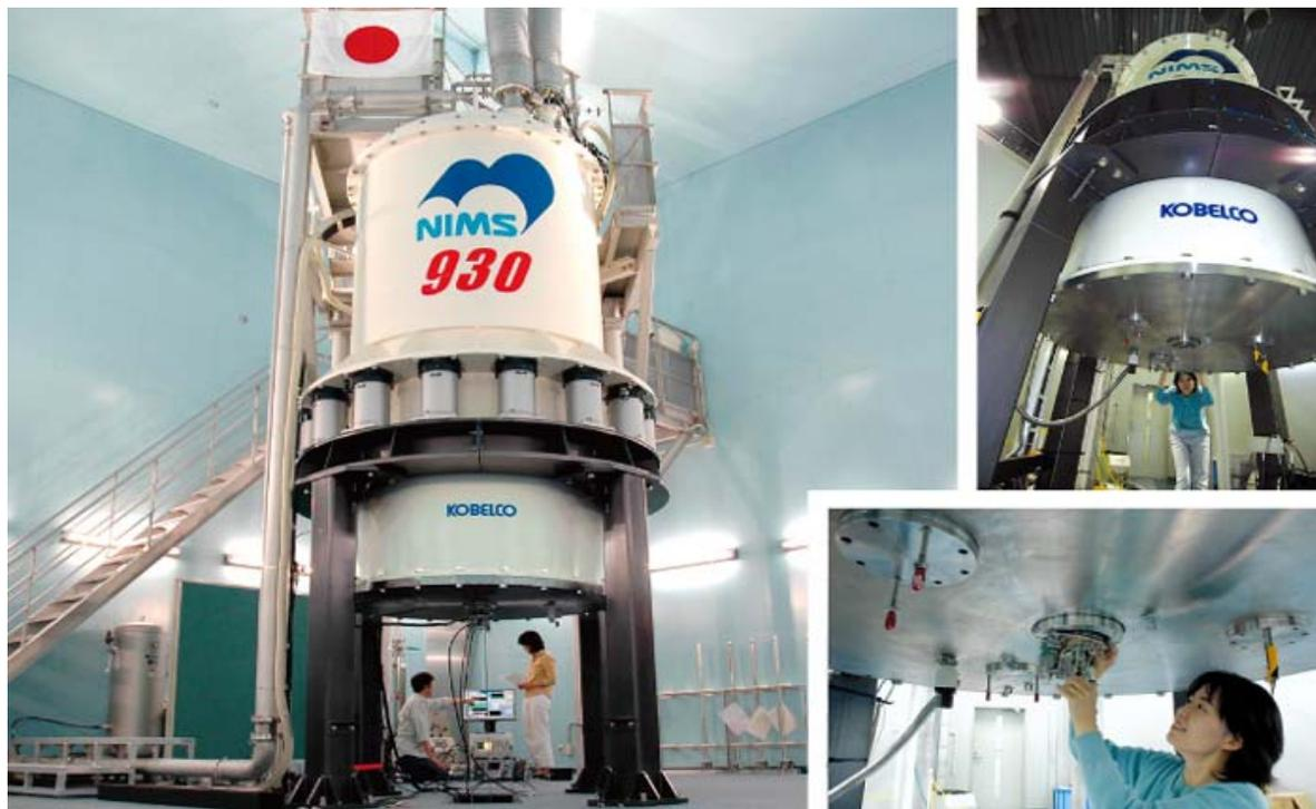
茨城県つくば市, 独立行政法人物質・材料研究機構(NIMS)にある930MHz固体専用NMR装置(21.9T). NIMSが理研, 日本電子, 神戸製鋼の協力で開発した(2004年).
