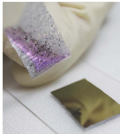
図1:スコッチテープ法により剥がした試料(左)を、 $SiO_2$ 基板(右)に転写する。(写真は、柘富龍一氏、渡辺悠樹氏提供)
