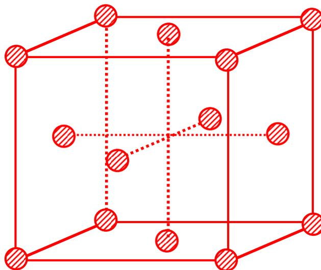
このように考えていくと、7種類の結晶系すべてについて、体心に原子がある場合、面心(6面全部)に原子がある場合、底心(2面の中心)に原子がある場合と場合分けして考える必要が出てくるわけだが、単体格子のとり方を変えると
