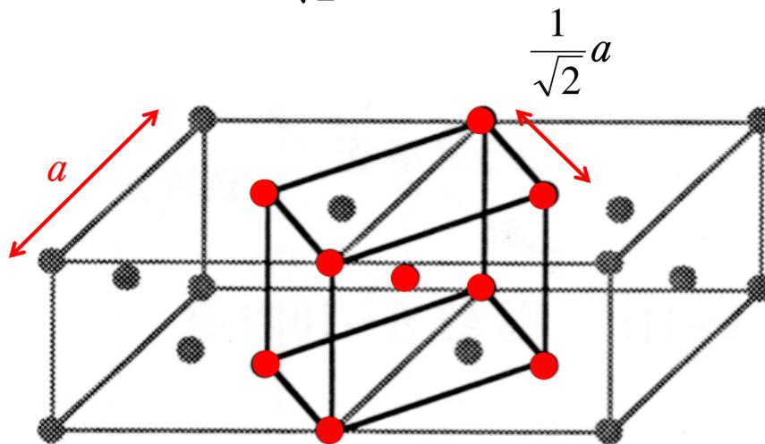
このように、単位格子の取り方によって重複する場合がありますために7種類の結晶系すべてにP, I, F, Cの4種類があるわけではなく、合計14種類になっている。
