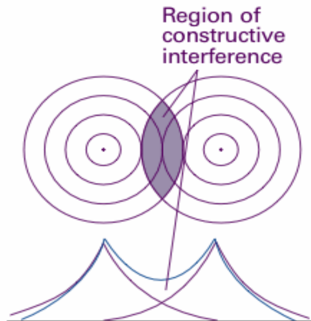
図11・17 2個のH1sオービタルが重なり合って \sigma オービタル \psi_+ を形成するときに強め合う干渉が起こる.
