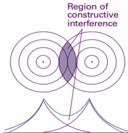
図11・17 2個のH1sオービタルが重なり合っ \sigma オービタル \psi_+ を形成するときの強め合う干渉が起こる.
