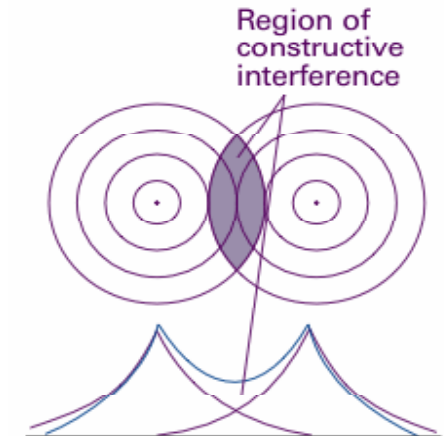
図11・17 2個のH1s軌道が重なり合っ \sigma 軌道 \psi_+ を形成するとき強め合う干渉が起こる.
